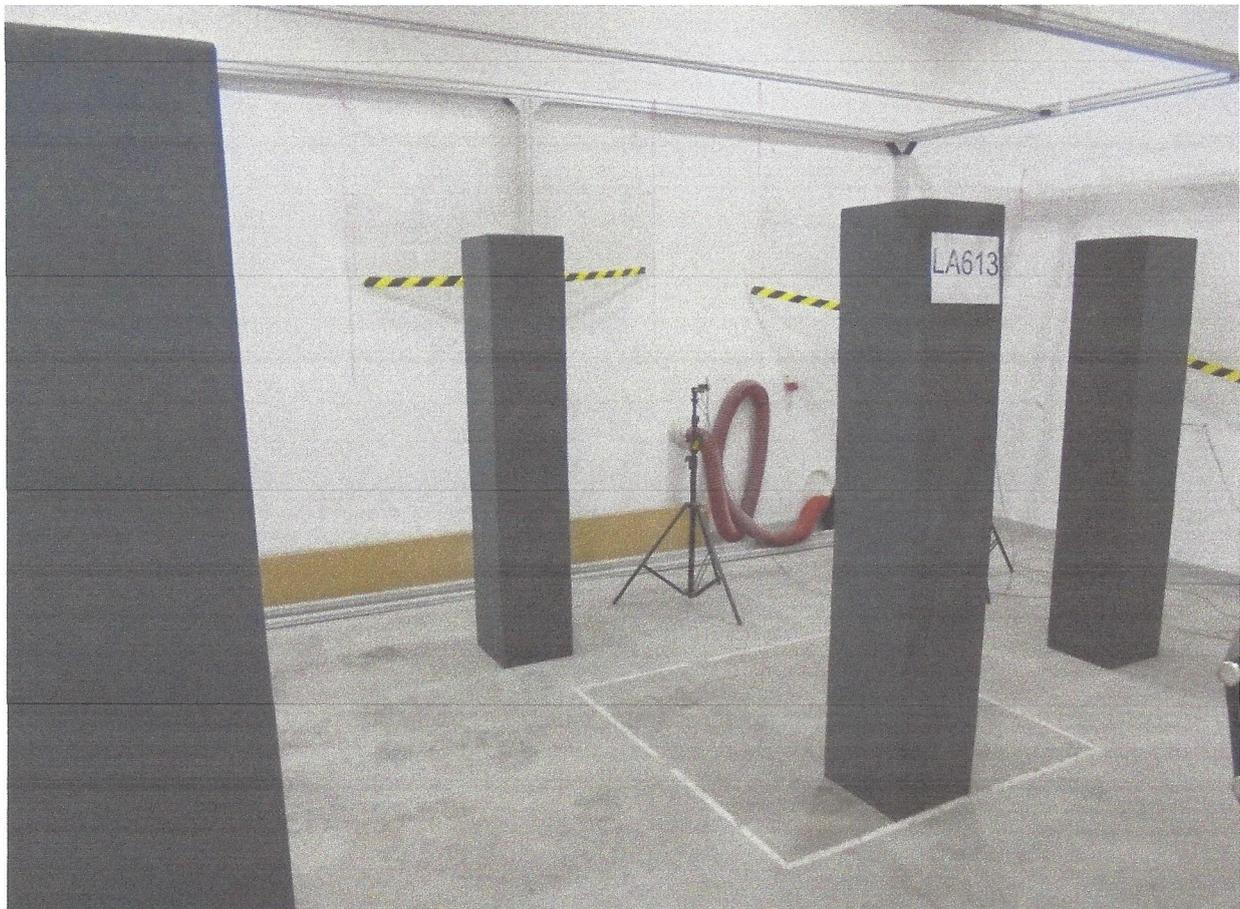
Abb. 1. Prüfobjekt LA613 - Schallabsorber der Firma Creative Design Group Szymon Rychlik - in der Nachhallkammer des Labors für Vibrations- und Akustikprüfungen des CTO S.A.
