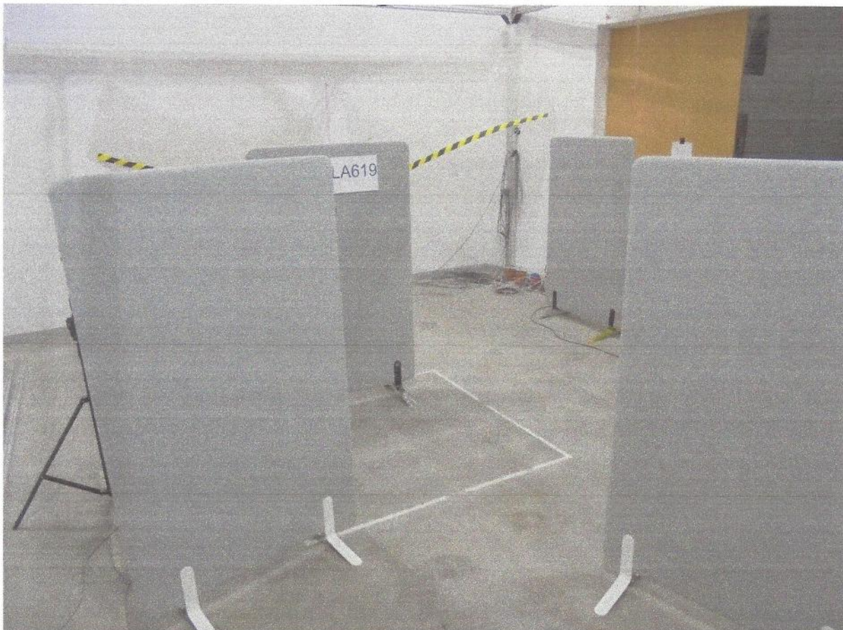
Abb. 1. Bild der Probe LA619, Akustikplatten von "Creative Design Group Szymon Rychlik", im Hallraum im Labor für Vibroakustische Prüfungen bei CTO S.A.
