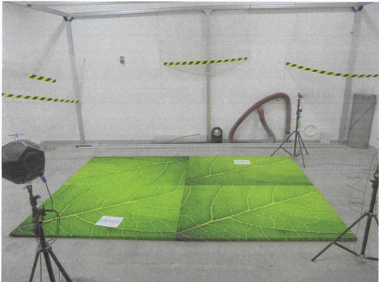
Abb. 1. Testprobe LA1019, Absorptionsplatten mit dem Aufdruck PRINT von CHUSH CREATIVE DESIGN GROUP, im Hallraum im Labor für Vibroakustische Prüfungen bei CTO S.A.
